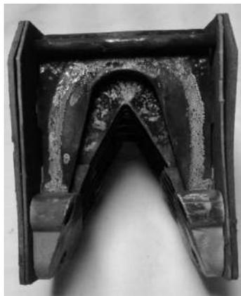
Рис. 1. Дугогасительная камера автоматического выключателя А3792У со следами придифрагменного плазмообразования
